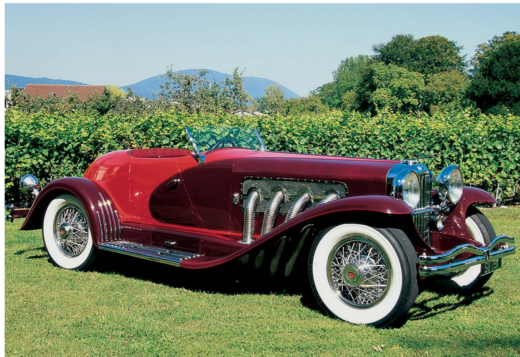
Duesenberg J, Bj. 1932. Achtzylinder-Reihenmotor. 6871 cm 3 . 265 PS. 187 km/h. 20 s 0 - 160 km/h. Leihgeber: Collection „Gaston“
