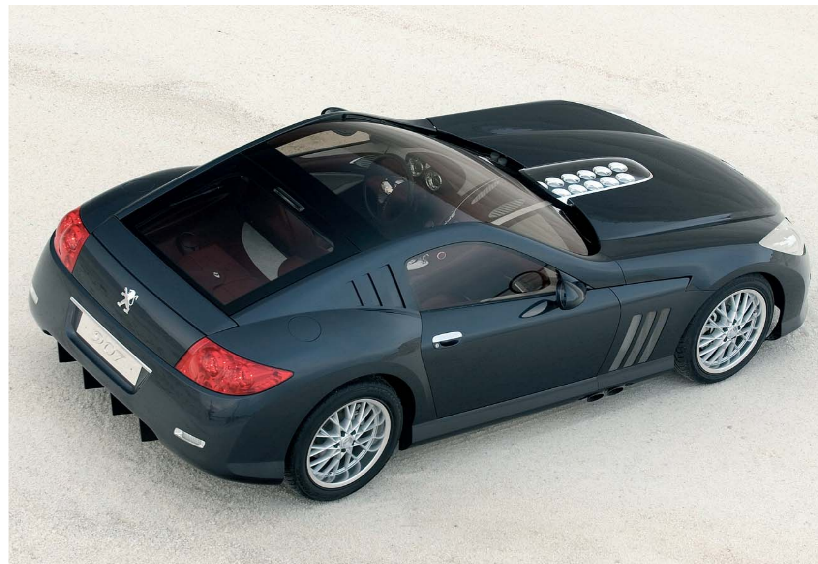
Peugeot 907, Bj. 2004. V12. 5892 cm 3 . 500 PS. über 300 km/h. Leihgeber: Automobiles Peugeot
